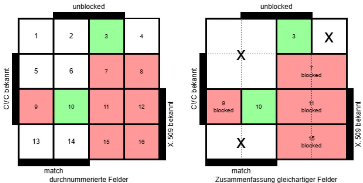
Abbildung 17: Karnaugh-Veitch Diagramm zur "import"-Methode
